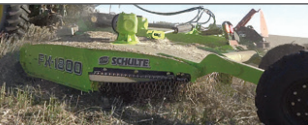
Außenborddrehung verhindert, dass sich Material unter dem Deck aufbläst
