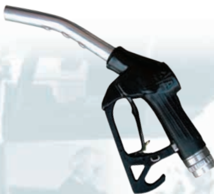
Artikelnr. 5800 ZVA AUTOMATISCHE PISTOLE ZVA-ELAFLEX Professionelle Zapfpistole für Dieselöl mit Vorrichtung zum automatischen Stoppen des Flusses bei vollem Tank. Ausgestattet mit Drehanschluß 1" und Filter am Eingang zum Schutz gegen Unreinheiten. Durchfluss MAX 80 Liter/min, ideal für die Versorgung von PKW und LKW.
