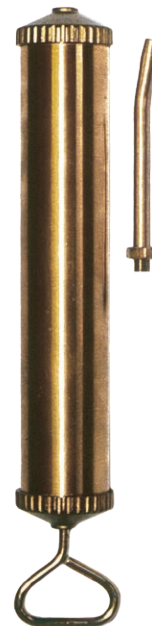
Druck- und Saug SYRINGE für Differentialgetriebeöl. Messingkörperinhalt 1000 gr.
